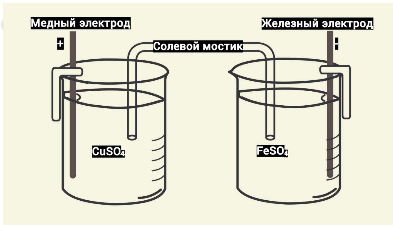
В каждый стаканчик помещают магнитную мешалку. К электродам подключают вольтметр с помощью соединительного провода «2 крокодила». Положительную клемму (красную) закрепляют на медном электроде, отрицательную (черную) – на железном. Вольтметр подключают к учебно-лабораторному модулю, показания вольтметра должны быть положительными.
